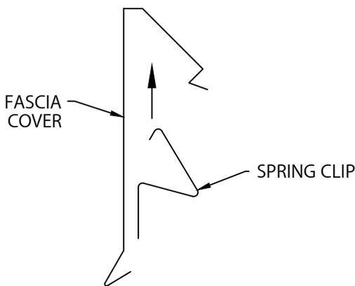
SIMPLY POSITION SPRING CLIP AS SHOWN AND PUSH STRAIGHT UP INTO COVER UNTIL SNAP LOCK OCCURS.
