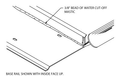
STEP 2 - MITER & SCUPPER BASE RAIL (PREPARATION)
