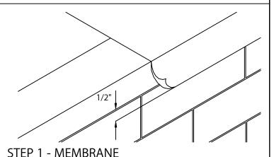
POSITION MEMBRANE OVER THE ROOF EDGE AND DOWN THE OUTSIDE FACE OF THE WALL, OVERLAPPING THE NAILER(S)
